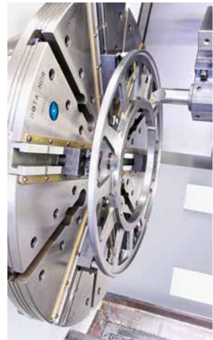
3 ... sondern auch labile Werkstucke wie hier einen Flansch, bei dem es auer auf einen sicheren auch auf einen deformationsarmen Halt ankommt (Bild: Schunk)
