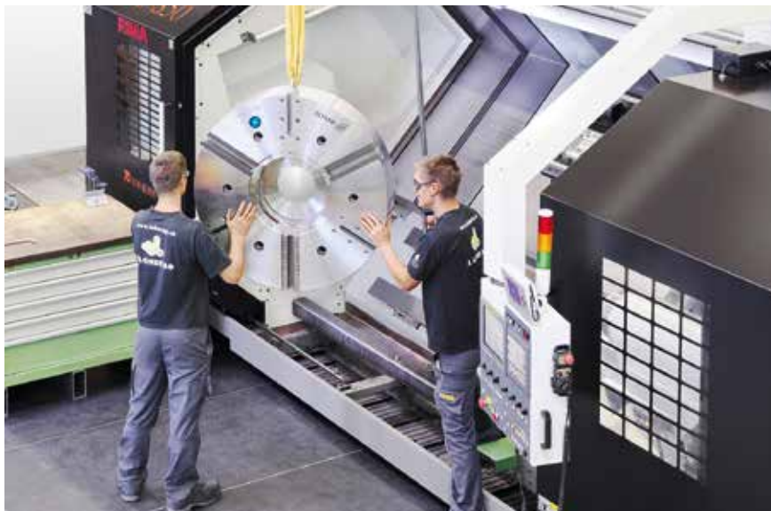
4 Es nimmt weniger als 60 min in Anspruch, die Drehmaschine auf das Kraftspannfutter Rota NC 1000 umzurüsten (Bild: Schunk)
