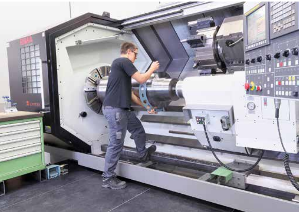
2 Christian Halg, Maschinenbediener bei Loher, schatzt die vielfaltigen Moglichkeiten der Schunk-Backenfutter. Das Rota NCR etwa fixiert nicht nur Growellen wie diese gerade zu messende, ... (Bild: Schunk)
