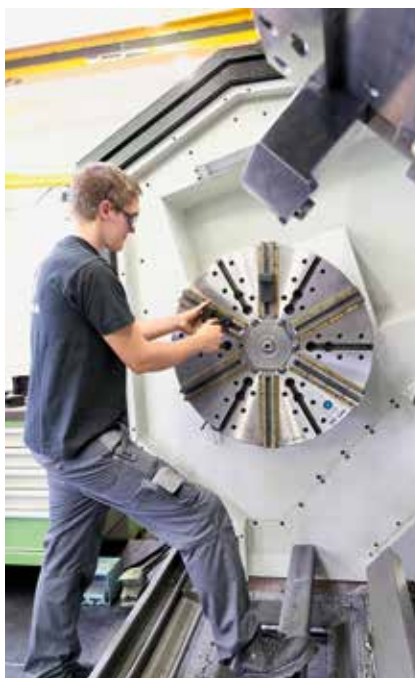
5 Innerhalb kürzester Zeit hat Christian Hälgl das Rota NCR auf einen neuen Backensatz umgerüstet (Bild: Schunk)
